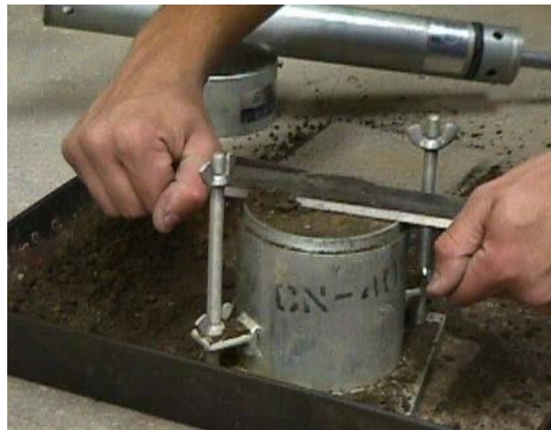
Figura 141 - 5. Enrase de la probeta
